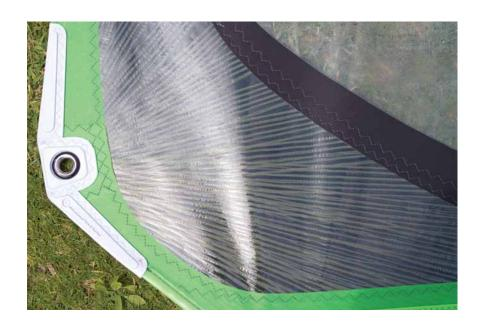
これらのパネルは熱と加圧によって薄く成形されるヨットのセイルづくりのハイテクを真似た構造を採用し、セイルのコーナーにかかる加重と同じように糸にも加重がかかるよう、糸を配置しています。
